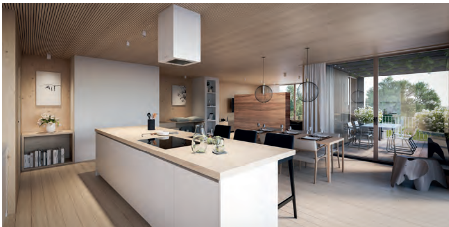
Construction en bois lamellé - murs non recouverts, mur en pisé vers le salon et plafond en élément bois apparent, qui réunit plusieurs fonctions (plafond, plancher, insonorisation acoustique).
