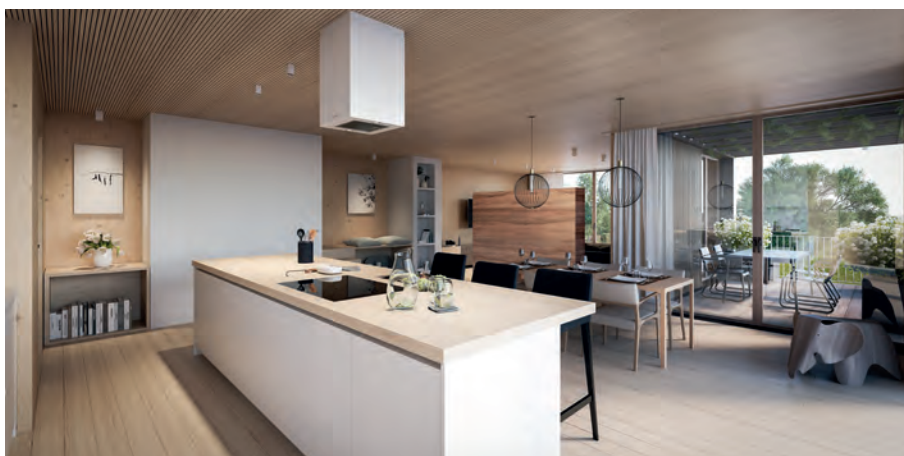
Massivholzbauweise – Sichtbare Holzwände, Stampflehmwand zum Wohnzimmer hin, multifunktionale akustische Holzdecke.
