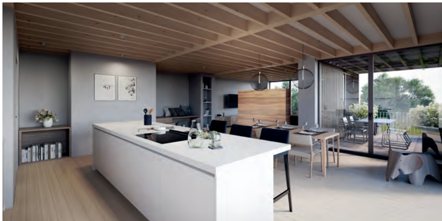
Holzrahmenbau – Wandoberflächen mit Kalkputz, Stampflehmwand zum Wohnzimmer hin, sichtbare Holzkonstruktion an der Decke.
